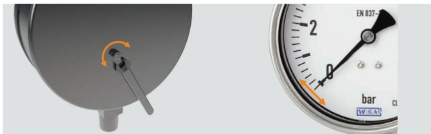
Ako je došlo do odstupanja kazaljke od točke nula (u tlačno rasterećenom stanju), namještanje točke nula moguće je izvršiti okretanjem šesterobridne matice sa stražnje strane instrumenta. Za namještanje šesterobridne matice neophodan je ključ za vijke veličine 7 mm.
