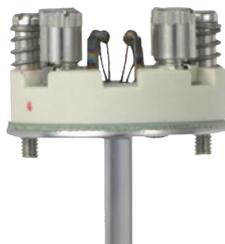
Preste uma atenção especial na montagem/desmontagem do elemento de medição. A superfície do cabo de isolamento mineral do sensor de temperatura não deve ser danificada! (Sem ranhuras, arranhões, etc.). Qualquer elemento de medição danificado deve ser substituído. É aconselhável a troca da conexão anti-propagação de explosão neste caso.
