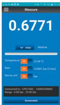
Über die App „myWIKa device“ und die WIKa-Wireless-Verbindung lässt sich das Gerät per Handy bequem für Log-Aufgaben konfigurieren. Während der Dichtemessung wird der Wert in der benötigten Einheit direkt auf dem Handy angezeigt.
