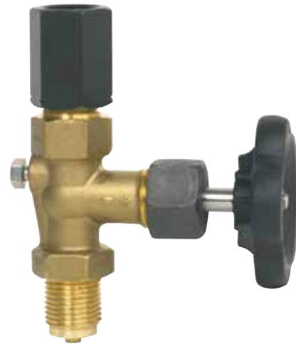
Zawór odcinający wg DIN 16270, nakrętka/ przyłącze zew. G 1/2, PN 250
